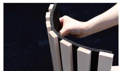
ベース裏面のフェルトに切り込みを入れると曲げることができます。カーブやウェーブ面などアール状の壁面にも柔軟に沿って施工可能で様々な形が表現できます。
